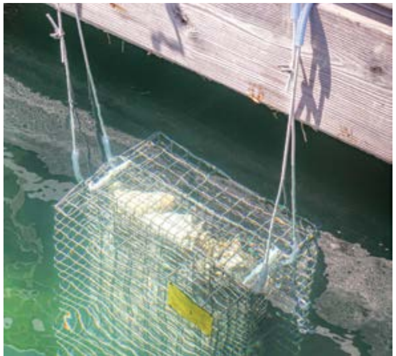
Figura 6. BIOHUTS fijado al muelle con tensores de acero inoxidable.
