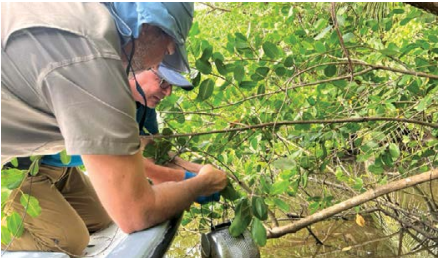
Figura 2. Colocación de envase de metal con rejilla con tres discos del muestreador pasivo POCIS. Cada disco de POCIS contiene el sorbente Oasis™ Balance Hidrofílico-Lipofílico (HLB, por sus siglas en inglés) que permite capturar eficientemente los PPCP, hormonas y sucralosa (Alvarez et al., 2004).
