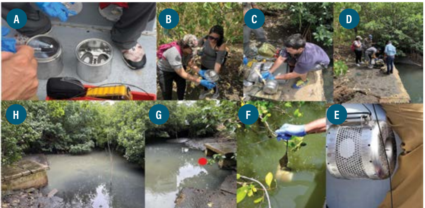
Figura 4. Despliegue de los muestreadores pasivos POCIS. En la foto A los tres discos POCIS se remueven de una lata de metal que vino sellada. En las fotos B, C y D se colocan los tres discos POCIS dentro del envase de metal con rejilla. La foto E muestra el ensamblaje del envase de metal con rejilla con los tres discos POCIS antes de sumergirlo en el agua (foto F). Las fotos B, C, D, G y H muestran la estación de la Laguna del Condado con el punto rojo indicando el lugar aproximado en donde se sumergió el envase de metal con rejilla que contenía los POCIS.
