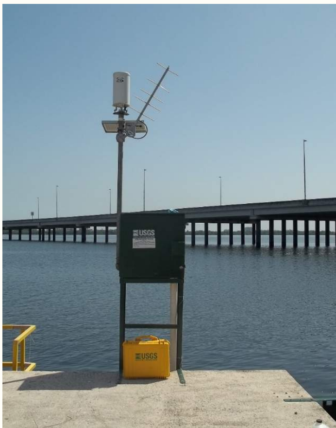
Figura 2. Estación para medir el nivel del agua en superficie instalada en la Laguna San José.
